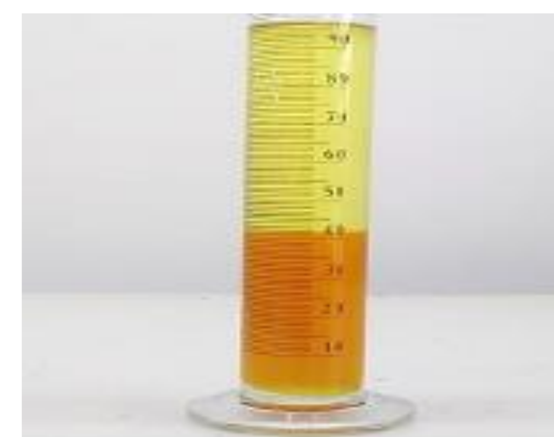
Fig. 1- Separación bifásica en la extracción de Bligh-Dyer del subproducto de lecitina de soya.
